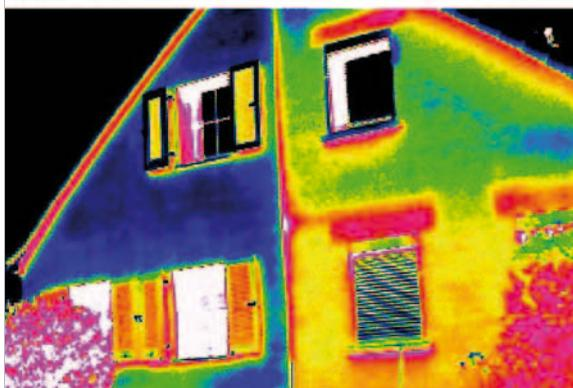
Die linke Haushälfte wurde neu gedämmt. Die Wärmebildkamera zeigt blaue Farben: Es geht wenig Wärme verloren. Häuser ohne Dämmung verlieren viel Energie: Die roten Farben zeigen es.
